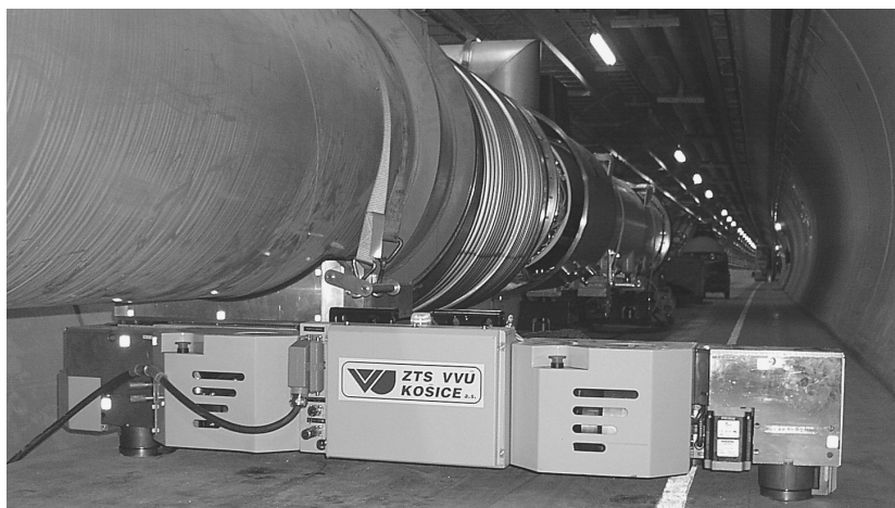
Presunúť takéhoto obra s presnosťou na dve desatiny milimetra je naozajstné umenie. Snímka archív ZTS VVU
